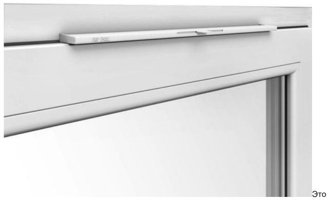
дополнительное устройство, которое монтируется в верхней части рамы. Оно связано с уличным воздухом и управляет его поступлением в помещение. Приток воздуха устанавливается в ручном или автоматическом режиме. Процесс проветривания в автоматическом режиме, управляется уровнем влажности в помещении.
